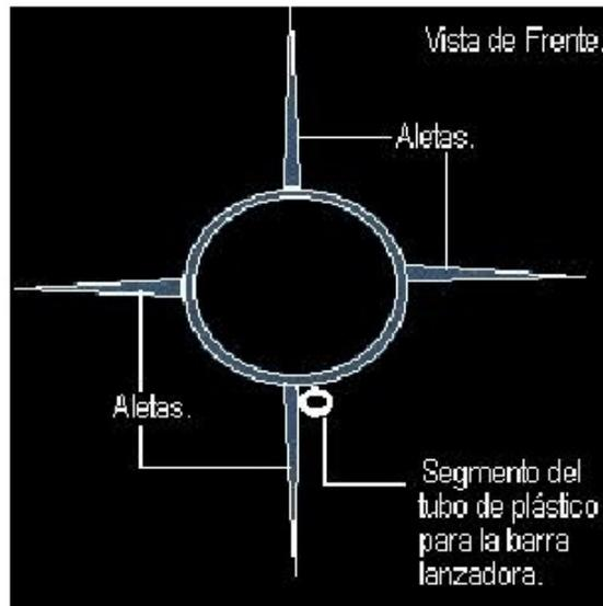
Cortando un gancho en la parte indicada, y doblándolo, quedará una barra lanzadora. Después de que se inserta la mecha en el motor, el cohete simplemente se desliza abajo en la barra lanzadora, la cual se coloca mediante el segmento del tubo de plástico. El cohete deberá poder deslizarse fácil por el gancho, como el que se ilustra a continuación:
